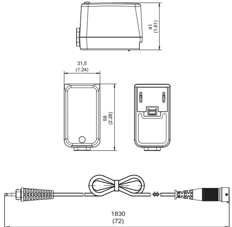
Alle Abmessungen in Millimeter (Inch), Abweichung  $\pm 0,5$  (0.02)
