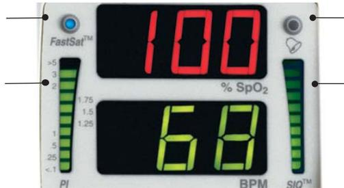
Der Alarm Status Indikator blinkt im Falle eines Alarmereignisses.
