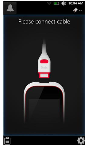
Ist kein Sensor bzw. nur ein nicht für Spot-Check-Messungen geeigneter Sensor am Kabel angeschlossen (und das Kabel mit dem Gerät verbunden), fordert eine Meldung zum Anschließen eines geeigneten Sensors an das Kabel auf.
